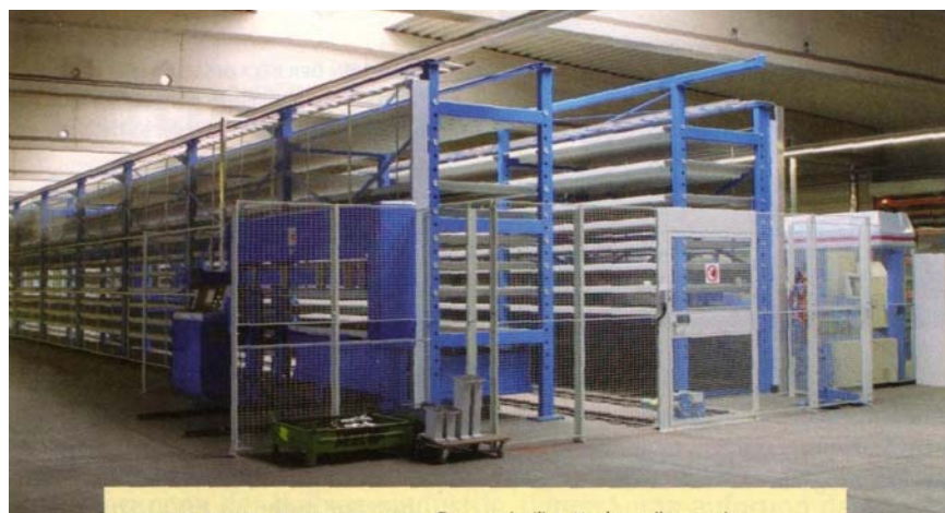
BILD 2. ERSTES GLIED DER KETTE: Das zweizeilige Hochregallager mit Ein- und Ausgabestation »Night Train« umfasst 149 Lagerplätze
